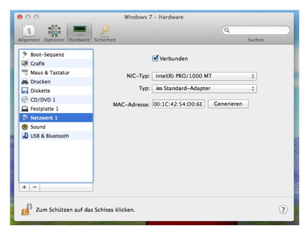
Die Adaptereinstellungen können hier je nach Bauart und Ausbauversion des Mac unterschiedlich sein. Ggf. mit verschiedenen Netzwerkadaptern probieren.
